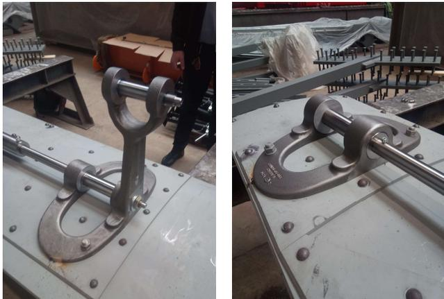
5) Montage des supports, construction, usinage et rivetage des aubes (acier)
