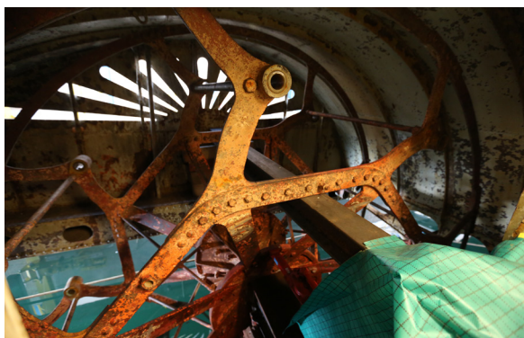
Usées par des millions de rotations durant des décennies, les roues à aubes d'origine des bateaux Vevey et Italie nécessitent une révision complète.
