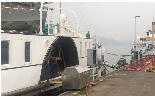
Au chantier naval de la CGN à Ouchy, le Simplon est à quai, ses roues à aubes démontées.
